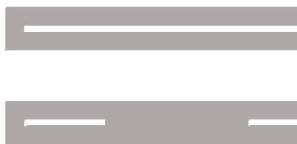
Znakowanie krawędzi (linia ciągła) i środka jezdni (linia przerywana)
